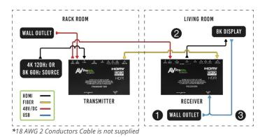
NOTE: THE AC-EXO-X-KIT MUST BE POWERED FROM BOTH UNITS IN ORDER FOR COMPLETE OPERATION.
